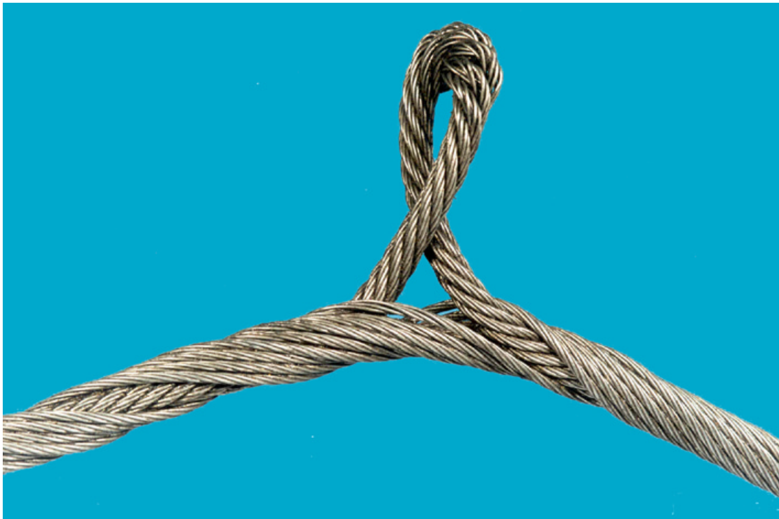
Figure D.16 — Extrusion du câblage intérieur d'un câble anti-giratoire
